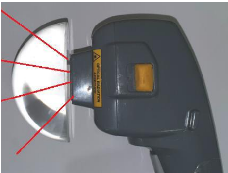
Abbildung 3: Messung des Outputs einer IPL-Quelle in einer Glashemisphäre, rechts die Ergebnisse für verschiedene IPL-Quellen
