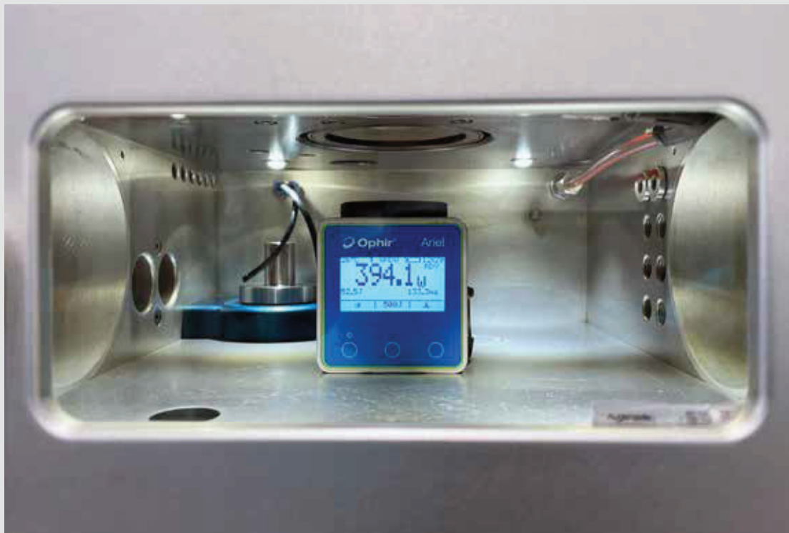
Das Ophir Ariel arbeitet völlig autark und lässt sich auch in einer kleinen Baukammer einfach platzieren. (Bild: mit Unterstützung des Instituts für Komplexe Materialien - Leibniz-Institut für Festkörper- und Werkstoffforschung e.V.)
