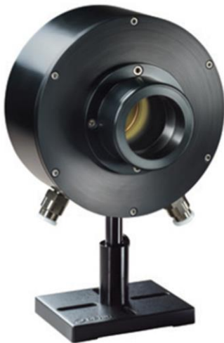
Abb. 2: Der 10kW Messkopf wurde mit einem zusätzlichen Backscatter-Filter ergänzt.
