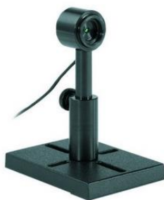
Abbildung 1: Der PD300-IRG deckt den Wellenlängenbereich von 800 bis 1700nm und einen Leistungsbereich zwischen 10 Pikowatt und 200 Milliwatt, bzw. ein Empfindlichkeit zwischen -90 dBm und 23 dBm ab.
