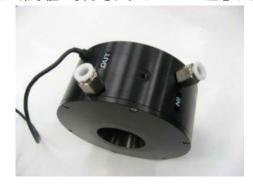
接続後は、しばらく冷却水を循環して、水漏れが無いことを確認してください。ホースの脱着時には、センサに水がかからないよう十分注意して行ってください。
