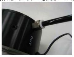
冷却水を流す方向が決まっているモデルの場合 "IN"・"OUT" のラベルが貼付けてありますので、ラベルに従って接続してください。 逆に接続すると正確な値が表示されませんのでご注意ください。
